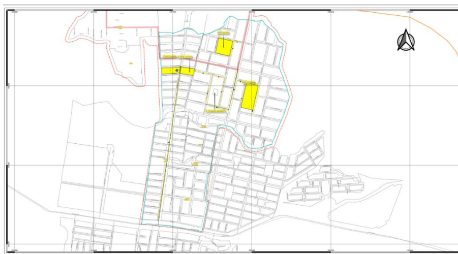
Ilustración 23. Malla vial e interconexiones del proyecto
